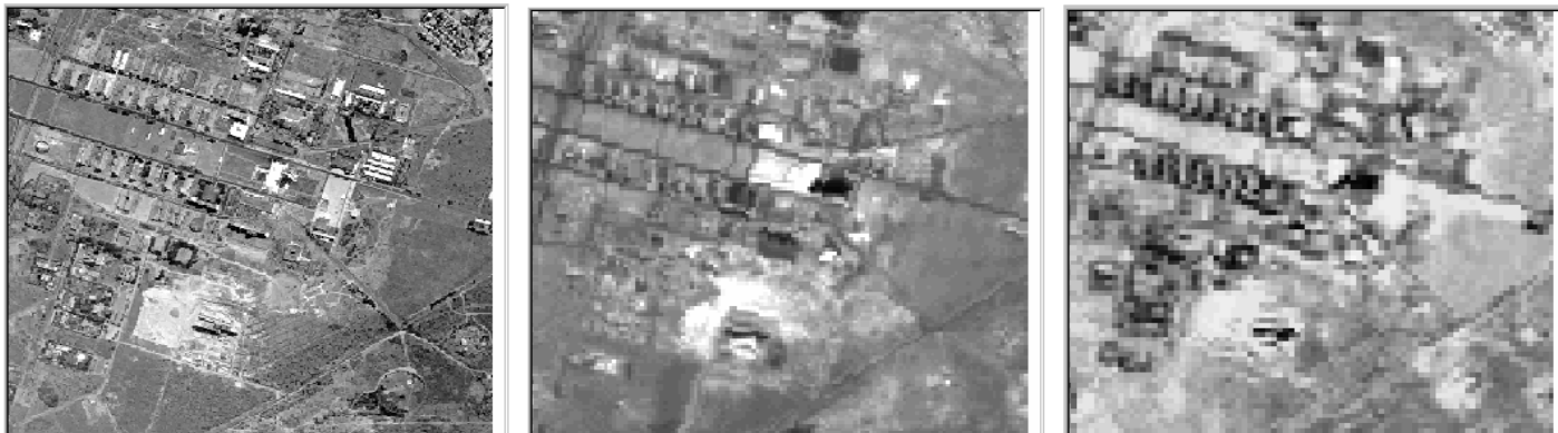
Figura 10 - Imagens, da esquerda para direita, resolução de 5 metros (sobrevoo), resolução de 20 metros (spot) e resolução de 30 metros (Landsat) – Fonte INPE.
